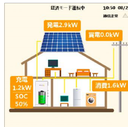
連系運転中の画面 (経済モード運転中の画面例)
